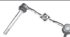
04801 bieleta puntal barra estabilizadora Eje delantero, izquierda 2.8 HDi oe: 5087.52
