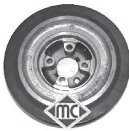
04290 Ø 162 - 6 CANALES motores 1.9D - 1.9TD - 1.9TDi hasta '98 INCA-IBIZA-TOLEDO-GOLF3-TRANS. r.o. 028105243T
