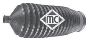
01648 kit 00648 fuelle kit fuelle cremallera dirección manual
