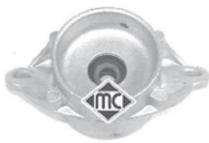
04430 Ø 10 mm soporte amortiguador eje trasero ambos lados C4 I oe: 5142.32 -5142.30
