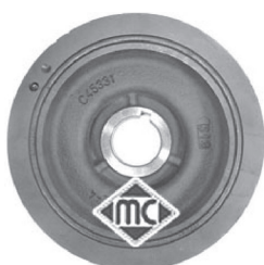
04477 Ø 152 mm - 6 canales PSA 2.0/2.2HDi motor DW10 (v8) hasta '04 salvo JUMPER-BOXER r.o. 0515.S4 - 0515.R9 - 0515.R2
