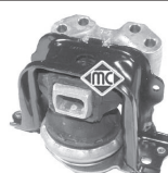
05219 soporte motor Eje delantero, derecha oe: 1839F4 -1839J2
