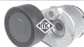
05157 Ø -65 mm, ancho: mm tensor correa alternador 1.5 dCi
