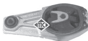
05182 soporte motor posterior;debajo oe: 1806.A6 -1806.J8
