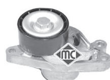
05421 Ø -60 mm, ancho: 26 mm tensor correa alternador 1.1 - 1.1 i - 1.4 16V oe: 5751.C8 -5751.97
