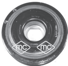
05651 Ø 156 mm - 7 canales 2.0 Diesel M9R TRAFIC II - ESPACE IV-MEGANE-II/III r.o. 8200767762
