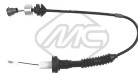
80012 longitud: 915/645 mm cable embrague automático 1.4 HDi eco 70 - 1.6 HDi 110 - 2.0 HDi 90 206 oe: 9634309980 -2150Y6
