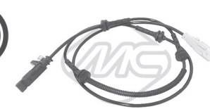
50192 Sensor activo sensor velocidad rueda - ABS eje delante- ro, ambos lados
