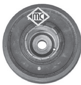
04553 Ø 143/151mm-5+5 canales series 3 y 5 E46/E39 motores 1.8D-2.0D r.o. 11232247565
