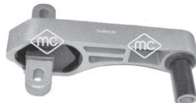
05674 soporte motor posterior;debajo 1.4
