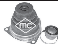
01139 kit fuelle kit fuelle transmisión con rodamiento 28mm lado de engranaje oe: 7701473830 Ø 28
