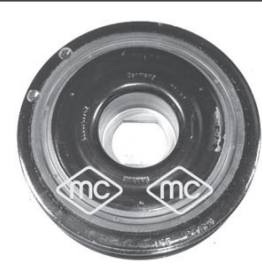
05651 Ø 156 mm - 7 canales 2.0 DCi motor M9R ALMERA - PRIMASTAR-QASQHAI r.o.
