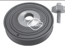
04611 Ø 151 mm - 7 canales polea cigüeñal 2.0 16V - 2.0 16V Turbo - 2.0 Renault Sport M II
